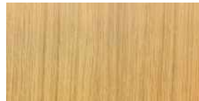
Tranché sur rive
