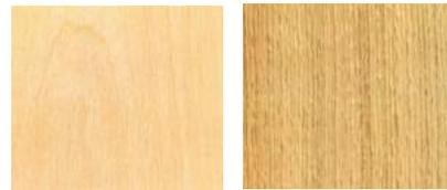
**GRANO DE BORDE (EG) O GRANO VERTICAL (VG) (EDGE GRAIN (EG) OR VERTICAL GRAIN (VG)):** Una o varias piezas aserradas en ángulos rectos aproximadamente a los anillos de crecimiento anuales de modo que los anillos formen un ángulo de 45 grados o más con la superficie de la pieza que resulte en líneas de grano rectas y ajustadas.
