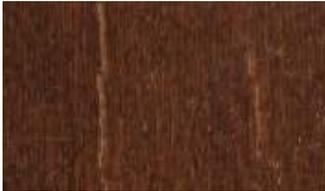
**MARCAS (CHECKS):** Pequeñas correas paralelas al grano de madera, causadas principalmente por cepas producidas durante el secado y/o el curado.
