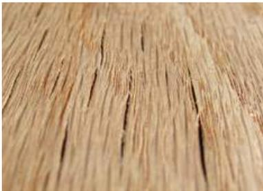
**MARCAS DE ASTILLA (CHIP MARKS):** Depresiones superficiales o sangrantes en o en la superficie de madera vestida provocados por afeitaciones o chips que se insertan en la superficie durante el vestir.
