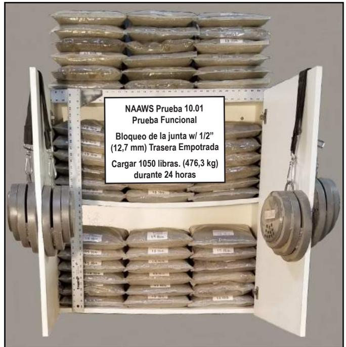
**UNA VEZ CARGADO,** el gabinete se ajustará durante al menos 24 horas, se retirará la carga y se volverá a examinar y documentar cualquier signo de falla de la carpintería, aclaramiento lateral de la estantería, alineación de puertas/operación o problemas de tolerancia a la brecha.
