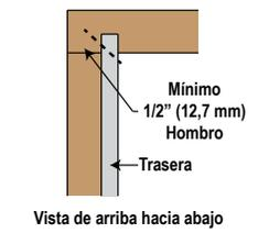
14 4 1 **USO DE** adhesivo reactivo con melamina en el perímetro de arado / ensambladura durante el montaje o de un adhesivo de 3/16" de fundición en caliente en el perímetro del hombro después del montaje; sin embargo, antes de instalar las tiras de anclaje.
