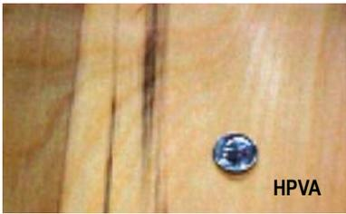
**RAYAS, MINERAL (STREAKS, MINERAL):** Descoloraciones alargadas de la sustancia maderera que contrastan considerablemente, generalmente causadas cuando el árbol absorbe y deposita minerales del suelo.
