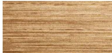
**CHAPA, RODAJA (VENEER, SLICED):** Chapa, en la que se mantiene firmemente un codazo de tronco o aserrado en una máquina de corte y se empuja hacia abajo hacia un cuchillo grande que corta la chapa. Véanse "Corte de Grieta", "Corte de Cuarto" o "Rodaja Lisa".
