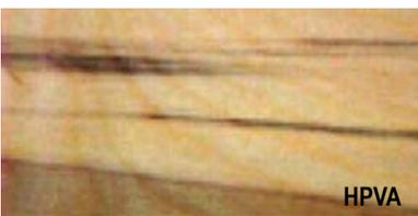
**RAYO (RAY):** Una de las estructuras radiales de un árbol que almacena la alimentación y la transporta horizontalmente a través del tronco. En cuarto de roble aserrado, los rayos forman una figura llamada salpicon.
