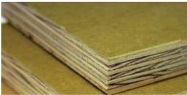
**SUPERPOSICIÓN DE DENSIDAD MEDIA (MDO) (MEDIUM DENSITY OVERLAY (MDO)):** Madera contrachapada de un núcleo de chapa fabricada con una superficie de fibra impregnada de resina termoendurecida unida a uno o ambos lados bajo calor y presión. MDO es especialmente adecuado para los acabados opacos (pintura); y la mayoría de las versiones son altamente resistentes a la humedad.
