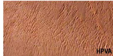
**GRANO ROTURADO (RUPTURED GRAIN):** Una rotura o ruptura en el grano o entre la madera de primavera y la madera de verano provocada o agravada por una presión excesiva sobre la madera por sazonamiento, fabricación o procesos naturales. El grano retornado aparece como una o varias separaciones distintas en la madera, como cuando se aplasta la madera de primavera dejando la madera de verano para separarla en uno o más incrementos de crecimiento.
